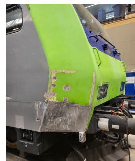
Reparatur eines Unfallschadens
