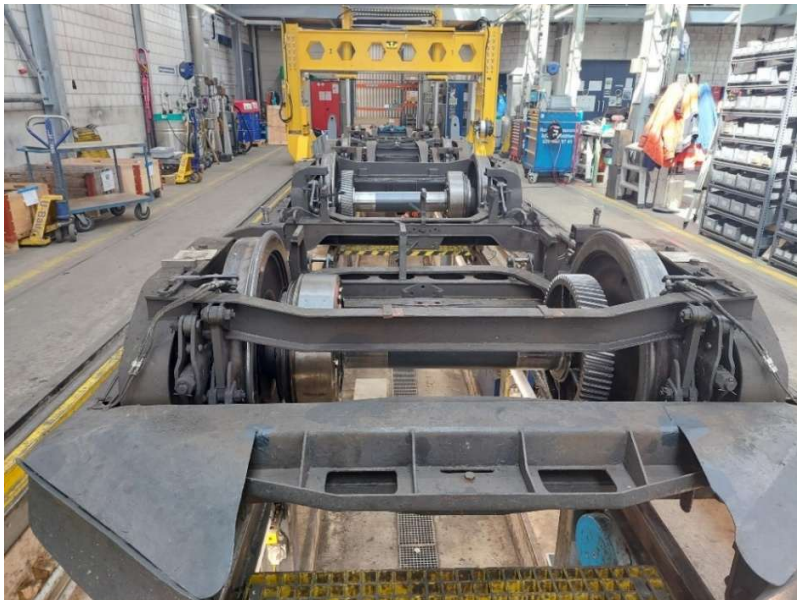
Revision an den Drehgestellen des Blauen Pfeils in Bönigen.
