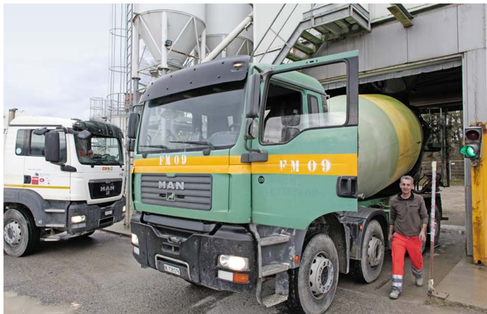
Bereit zum Transport. Der Frischbeton wird mit Fahrmischern zu den Einbauorten gefahren.
