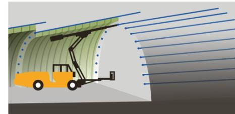
**1. Rohrschirm:** 15 m lange Rohre werden am Rand des Ausbruchs in den Fels gebohrt. Sie bilden einen Schutzschirm unter welchem der Ausbruch des Tunnels erfolgen kann.
